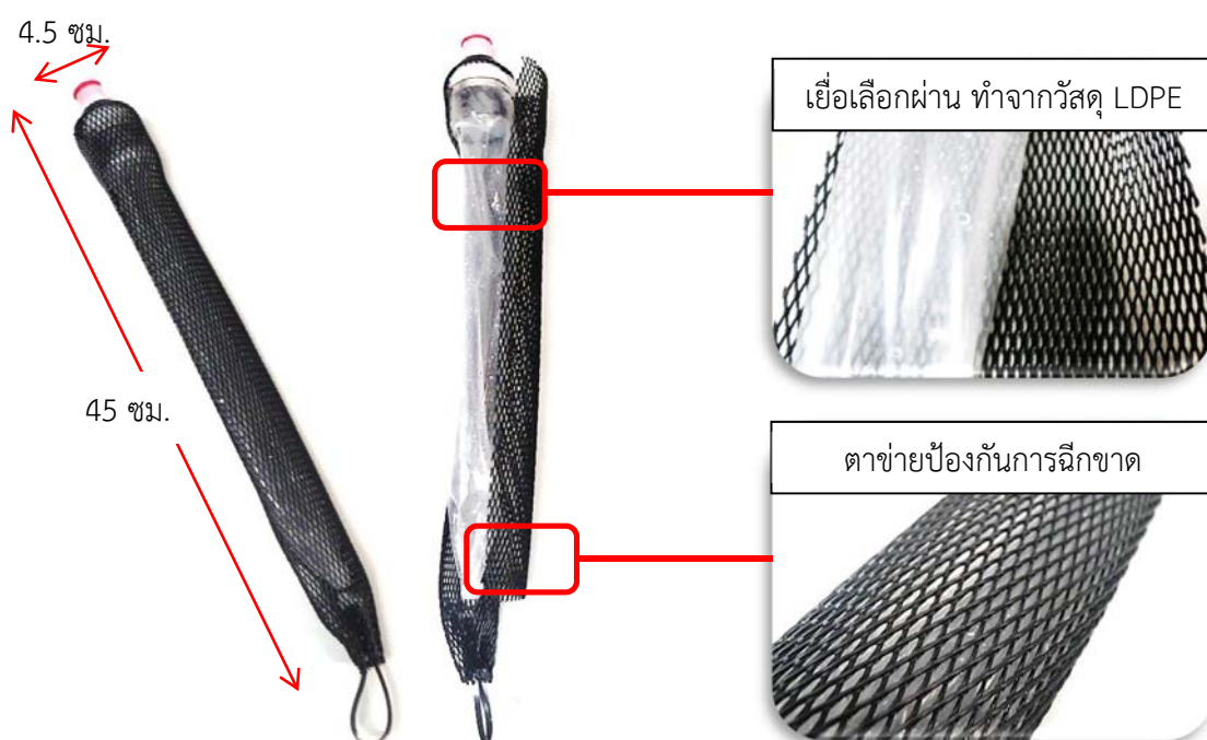
รูปที่ 1.2 แสดงส่วนประกอบของอุปกรณ์เก็บตัวอย่างน้ำใต้ดินแบบ Passive Diffusion Bag
