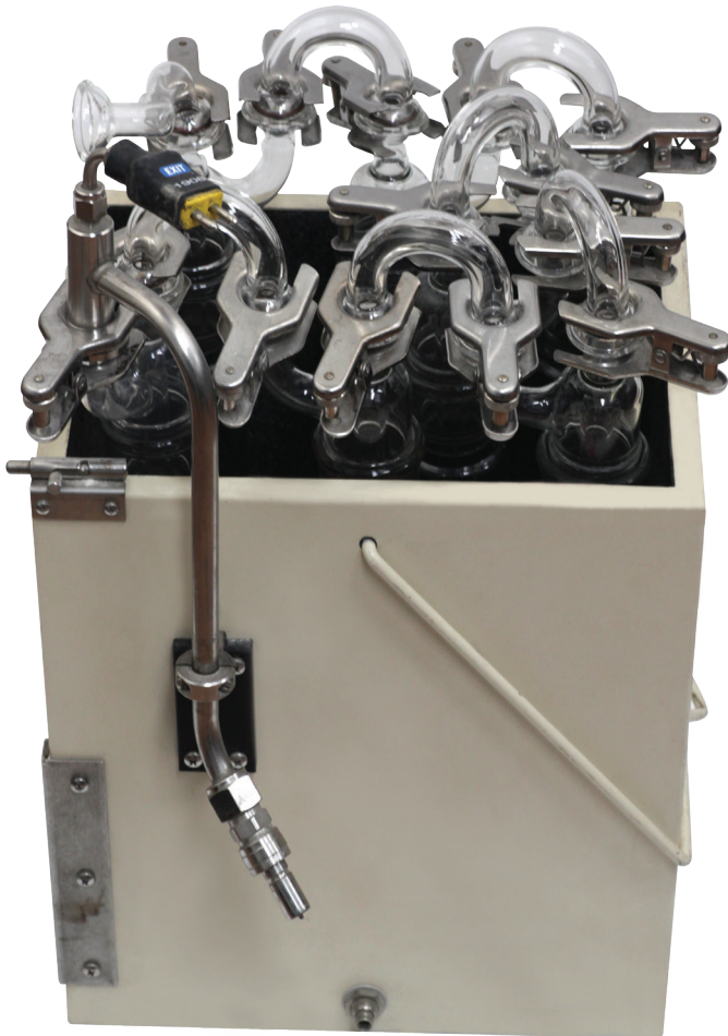
ภาพที่ 29-1x แสดงชุดควบแน่น (Condenser)
