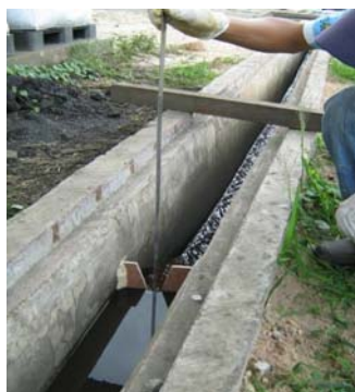
รูปที่ ๓.๙ การวัดความสูงของน้ำเสียเพื่อนำไปคำนวณหาอัตราการไหลของน้ำเสีย
