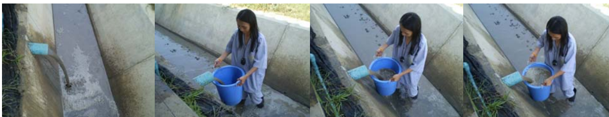
รูปที่ ๓.๖ การร่อนน้ำเสียจากปลายท่อเพื่อวัดอัตราการไหลของน้ำเสีย
