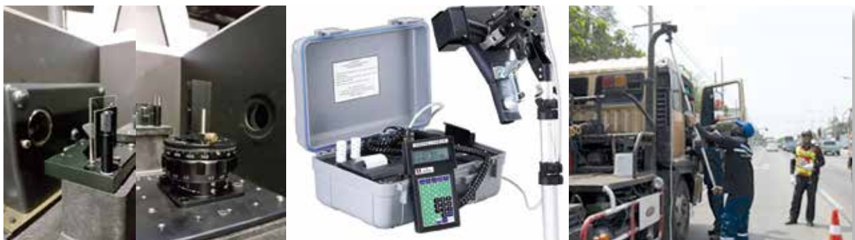
ชุดเครื่องมือสอบเทียบแผ่นกระจกสอบเทียบมาตรฐานสำหรับเครื่องวัดความทึบแสง (ซ้าย) เครื่องวัดความทึบแสงและการตรวจสอบตรวจจับวัดยานพาหนะควนดำ (ขวา)
