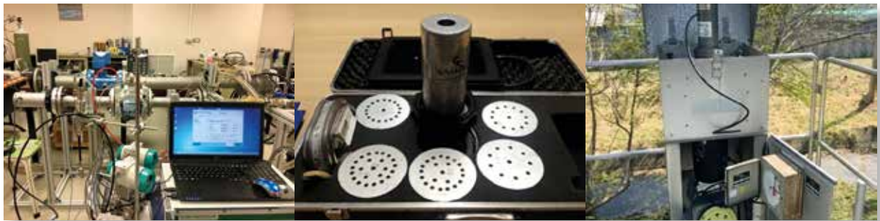
ชุดเครื่องมือสอบเทียบ Orifice Calibration Unit และการใช้ Orifice Calibration Unit ทำการปรับเทียบอัตราการไหลเครื่องวัดฝุ่นละออง (ปริมาตรสูง)
