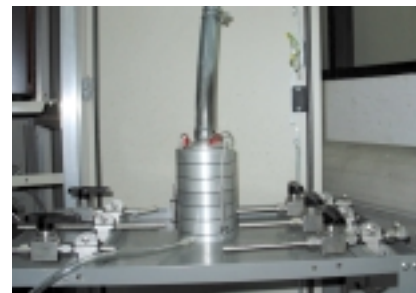
เครื่องมือเก็บและแยกขนาดฝุ่นละออง “Cascade Impactor”
