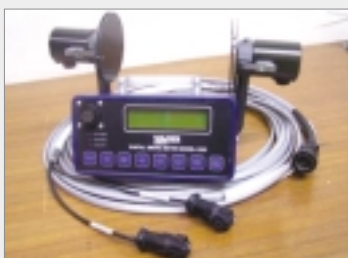
รูปที่ 41 เครื่องมือตรวจวัดควันทบระบบวัดความทึบแสงมาตรฐานสากล ยี่ห้อ Wager รุ่น 6500
