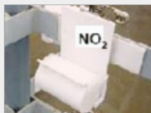
รูปที่ 36 วิธีการตรวจวัด แบบแพร่กระจายของก๊าซ (Passive Sampling Technique)
