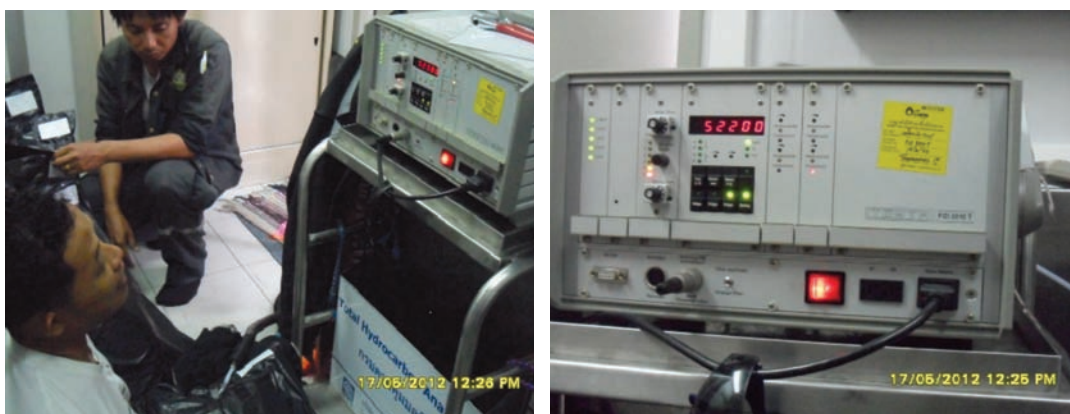
ภาพการวิเคราะห์ Total VOCs ด้วยระบบ FID : Method 25A
