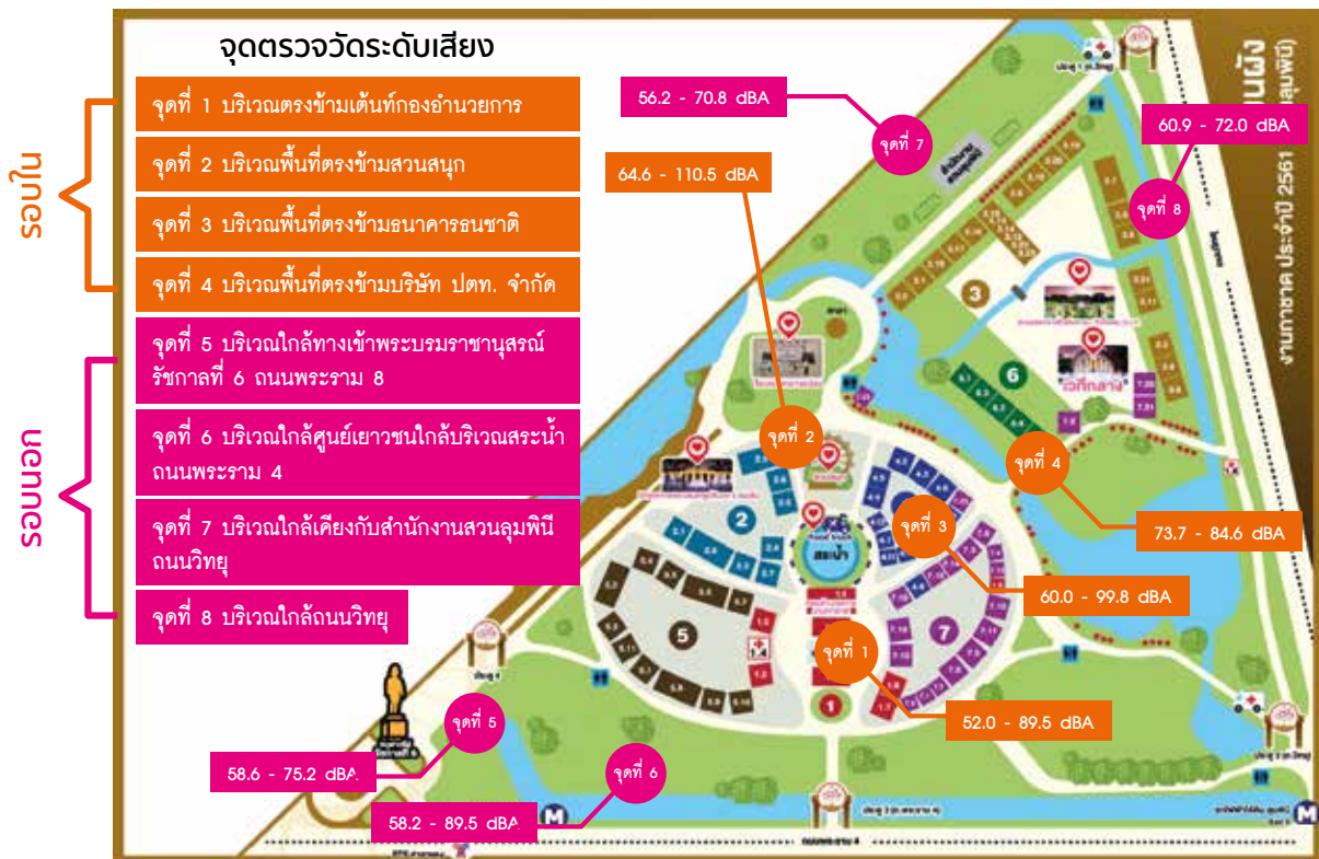
รูปที่ 8-2 แสดงผลการตรวจวัดระดับเสียงภายในพื้นที่จัดงานกาชาด ประจำปี 2561 หมายเหตุ: จุดที่ 1 - 3 และจุดที่ 5 - 8 แสดงค่าระดับเสียงเฉลี่ย ( L_{eq} ) 15 นาที จุดที่ 4 แสดงค่าระดับเสียงเฉลี่ย ( L_{eq} ) 8 ชั่วโมง
