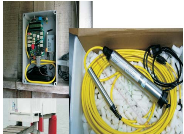
ชุดอุปกรณ์หัววัดระดับน้ำประกอบด้วยอุปกรณ์ควบคุมการทำงานและส่งข้อมูลผ่านเครือข่าย GPRS
