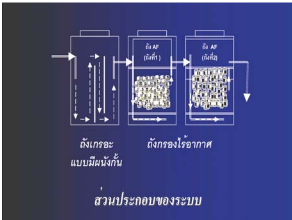
ระบบบำบัดน้ำเสียขนาดเล็กสำหรับบ้านเรือนในพื้นที่เกาะช้าง
