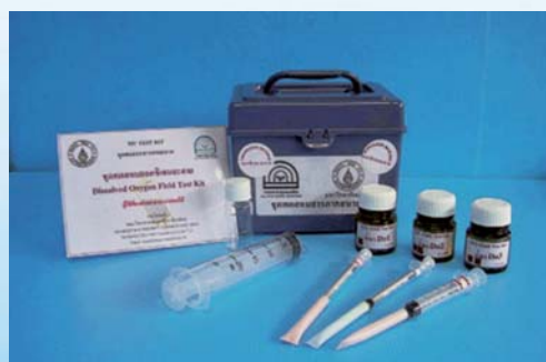
อุปกรณ์เก็บตัวอย่างน้ำและชุดทดสอบคุณภาพน้ำอย่างง่าย (Test Kit)
