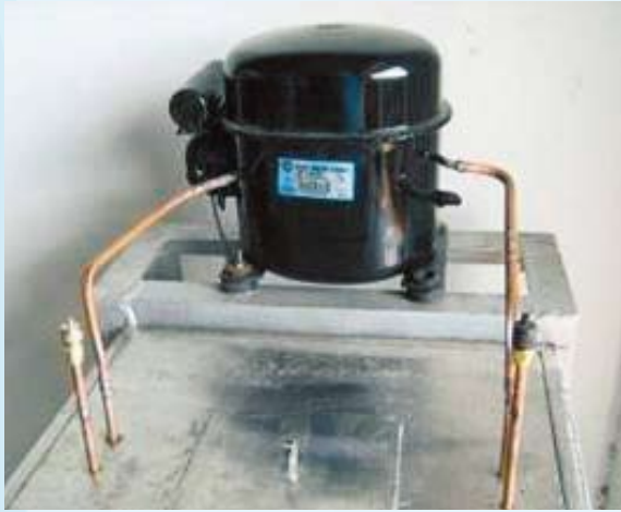
คอมเพรสเซอร์ทำหน้าที่อัดก๊าซชีวภาพลงถัง
