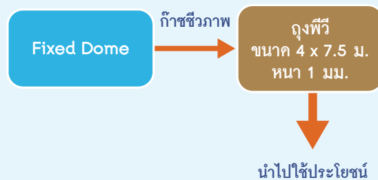
แผนผังการเก็บรวบรวมก๊าซชีวภาพสำรอง แบบถุงพลาสติกพีวีซี
