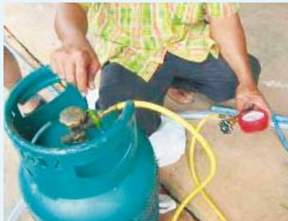
การบรรจุถังก๊าซชีวภาพลงถัง
