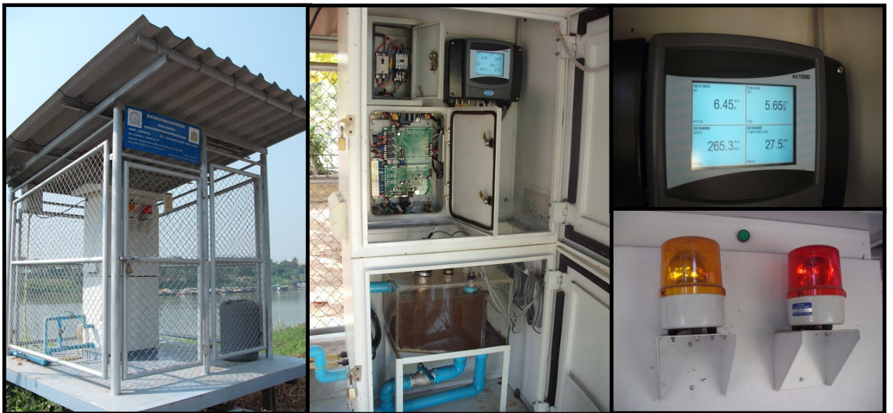
รูปที่ 1 อาคารสถานีตรวจวัดคุณภาพน้ำอัตโนมัติและเครื่องมือตรวจวัดคุณภาพน้ำภายในสถานี
