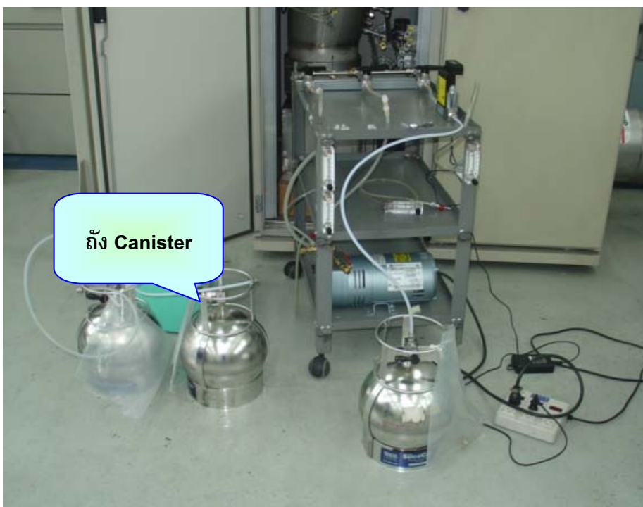
รูปที่ 4-5 การเก็บสารมลพิษ สารประกอบอินทรีย์ระเหย (VOCs) โดยใช้ถัง Canister
