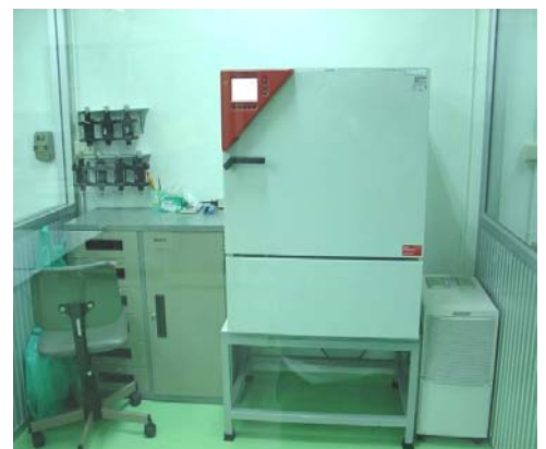
รูปที่ 5 ตู้อบกระดาศกรง พร้อมระบบควบคุมอุณหภูมิและความชื้น
