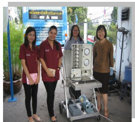
รูปที่ 13 นักศึกษาฝึกงานทดลองเก็บตัวอย่างฝุ่นละอองขนาด 1-10 \mu\text{m} โดยใช้เครื่องมือในห้องปฏิบัติการฯ
