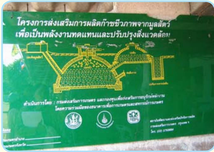
องค์ประกอบของระบบบำบัดน้ำเสียและผลิตก๊าซชีวภาพแบบโดมคงที่
