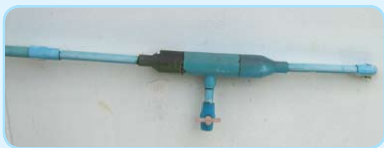
ชุดกรองก๊าซโดยใช้ฝอยเหล็กก่อนเข้าคั่วเรือนสำหรับเตาหุงต้ม
