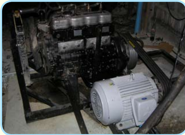
รูปแสดงมอเตอร์และคอมเพรสเซอร์ที่ทำการดัดแปลงจากเครื่องยนต์
