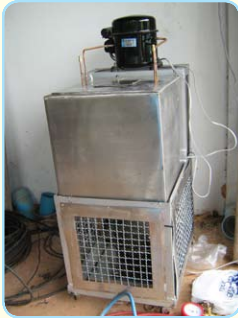
ชุดสูบล้อดและลดอุณหภูมิของก๊าซชีวภาพ
