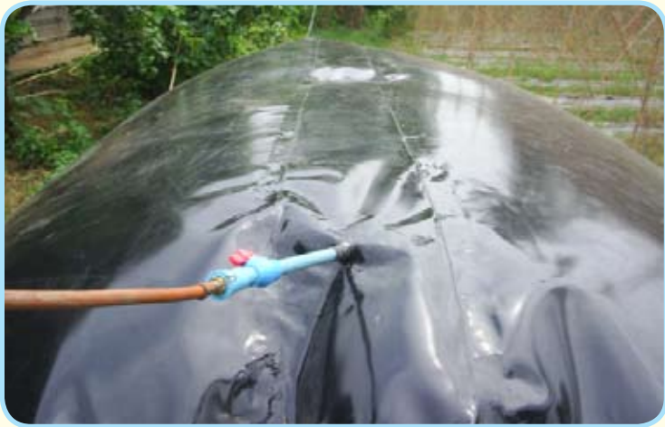
รูปแสดงการต่อท่อและถุงเก็บสำรองเพื่อเก็บรวบรวมก๊าซชีวภาพ
