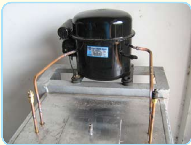
รูปแสดงคอมเพรสเซอร์ทำหน้าที่อัดก๊าซชีวภาพลงถัง
