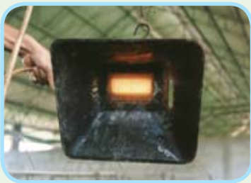
รูปการใช้ก๊าซชีวภาพกับหัวกกกลูกลูกร
