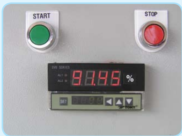
รูปแสดงหลอดไฟเตือนกรณีปริมาณออกซิเจนเกินระดับที่กำหนดไว้
