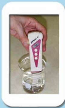
รูปที่ 2 การตรวจวัดค่าความเป็นกรด-ด่าง ในภาชนะบรรจุตัวอย่างน้ำ
