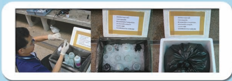
รูปที่ 8 เก็บขวดตัวอย่างน้ำลงในกล่องรักษาความเย็นที่บรรจุน้ำแข็งไว้
