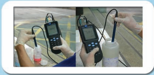
รูปที่ 6 การสอบเทียบค่าเครื่องมือ และการตรวจวัดค่าพีเอช และอุณหภูมิ
