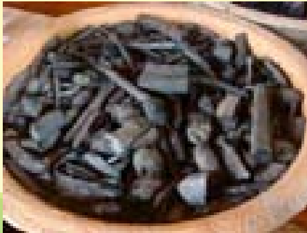
ถ่านชีวมวลหรือถ่านไบโอชาร์ ที่ได้จากเตาไบโอชาร์
