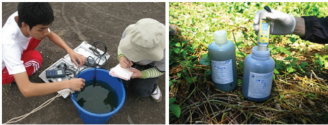
การตรวจวัดค่า pH และอุณหภูมิของน้ำตัวอย่าง โดยใช้ pH Meter
