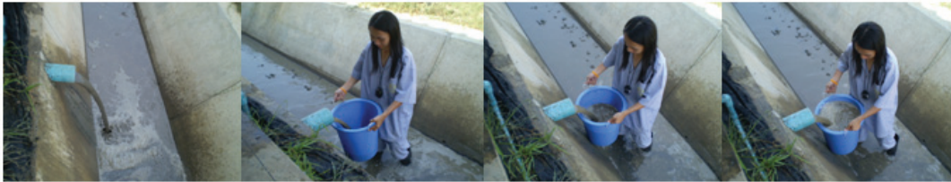
การร่อนน้ำจากปลายท่อเพื่อวัดอัตราการไหลของน้ำเสีย
