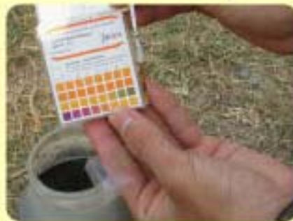
การตรวจพีเอชในน้ำที่ออกจากถังกรองไร้อากาศโดยใช้กระดาษวัดพีเอช
