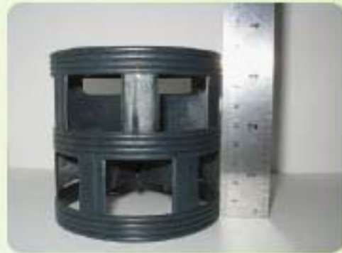
ตัวกลางพลาสติกที่ใช้ในถังกรองไร้อากาศ
