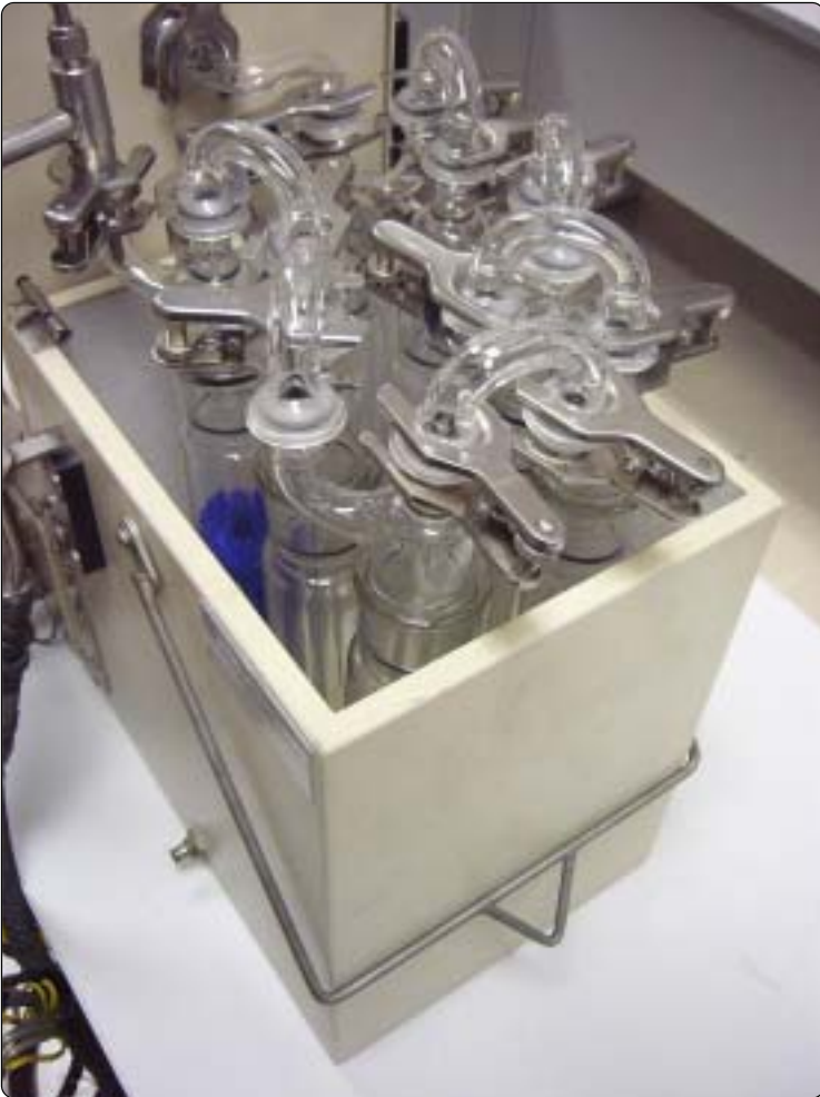
ภาพที่ 29-1ข แสดงชุดควบแน่น (Condenser)
