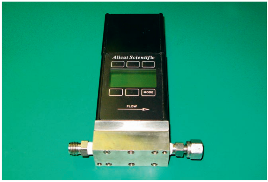
รูปที่ 3 เครื่องวัดอัตราการไหลของอากาศ
