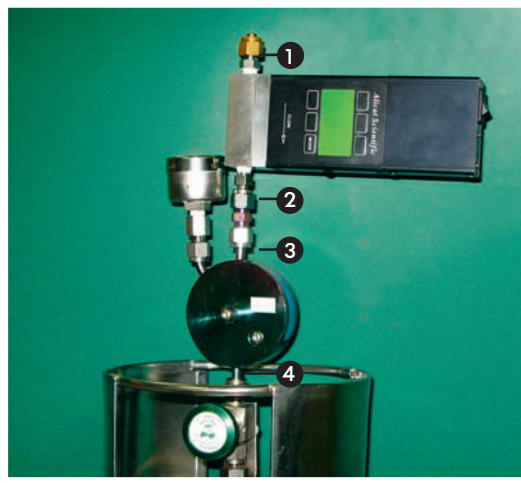
รูปที่ 5 ภาพแสดงการต่ออุปกรณ์เพื่อทดสอบการรั่ว
