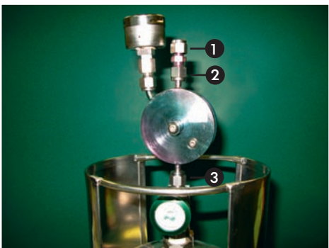
รูปที่ 7 แสดงการต่ออุปกรณ์ควบคุมอัตราการไหลกับถังเก็บตัวอย่างอากาศ
