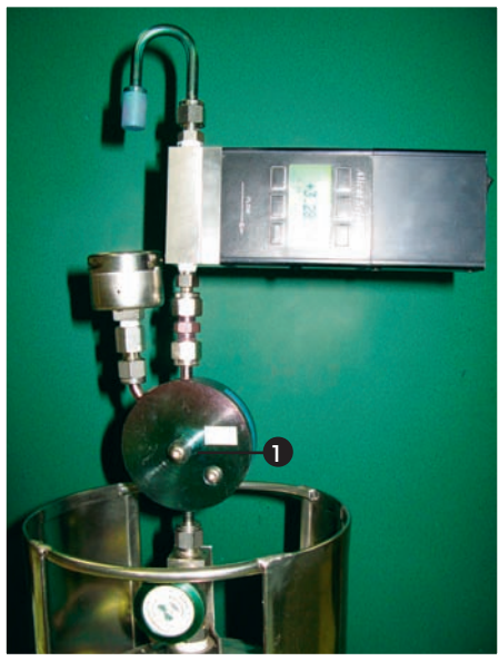
รูปที่ 6 การต่ออุปกรณ์ควบคุมอัตราการไหลเพื่อปรับอัตราการไหล
