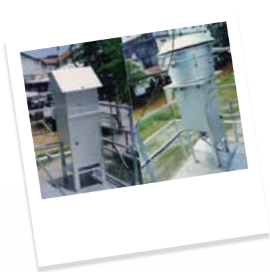
ภาพแสดงการตรวจวัดฝุ่นละอองในบรรยากาศ โดยใช้เครื่องมือ High Volume Air Sampler
