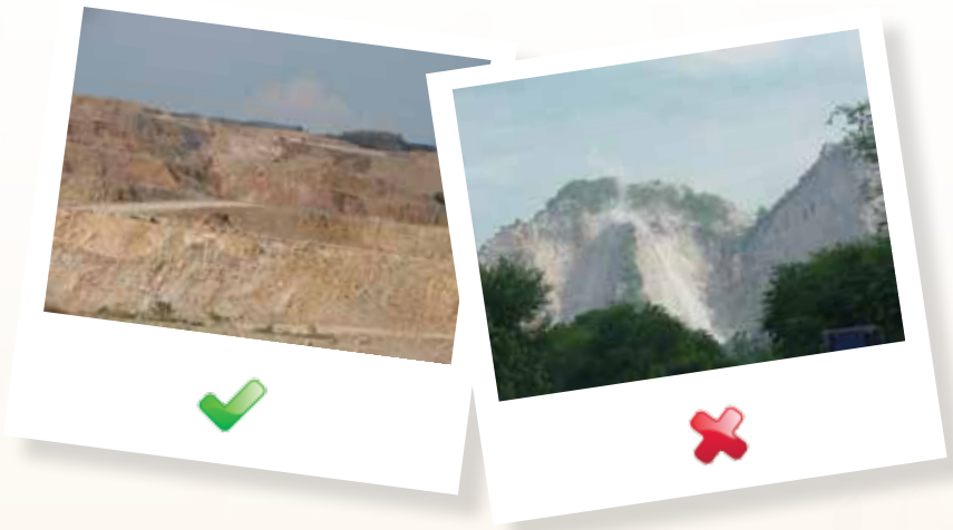
ภาพแสดงการเปิดหน้าเหมืองแบบขั้นบันได (ภาพซ้าย) และแบบหน้าผา (ภาพขวา)
