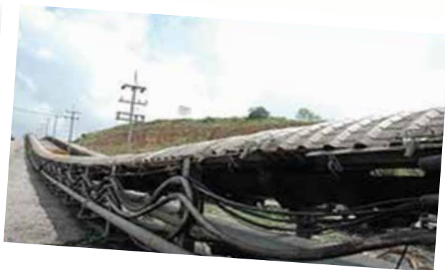
ภาพแสดงการปิดครอบสายพานตลอดแนวที่มีการขนส่งหิน
