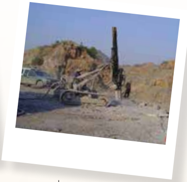
ภาพแสดงการเจาะระเบิดด้วยเครื่องจักร
