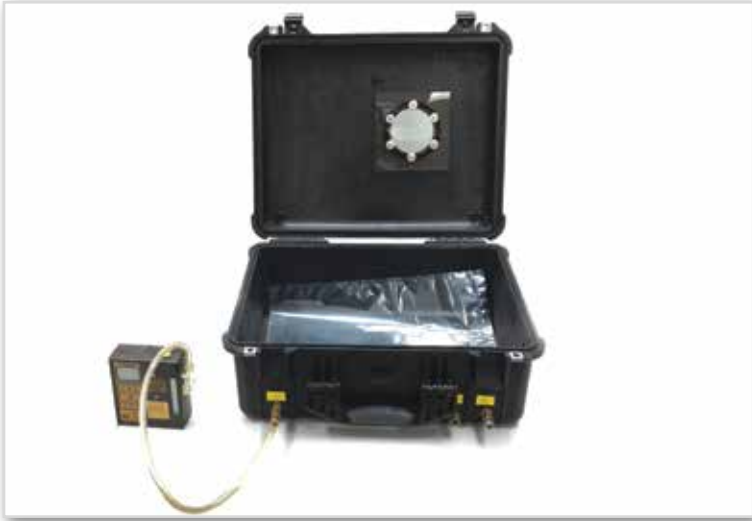
รูปที่ 3-6 แสดงการประกอบถุงเก็บตัวอย่าง (Sampling bag) เข้าในกล่องสุญญากาศ (Vacuum box)
