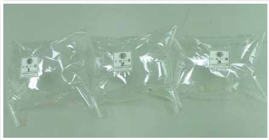
รูปที่ 3-11 ถุงที่ปราศจากกลิ่นขนาดความจุ 3 ลิตร สำหรับใช้เป็นถุงดมกลิ่น
