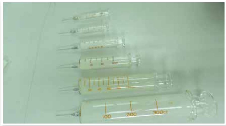
รูปที่ 3-12 กระบอกฉีดยา (Cylinder) สำหรับการเจือจางตัวอย่าง
