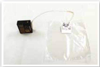
รูปที่ 3-3 กรณีไม่มีกล่องสุญญากาศ (Vacuum Box) สามารถใช้ปั๊มดูดอากาศจากปล่องไปยังถุงเก็บตัวอย่างกลิ่นได้โดยตรง
