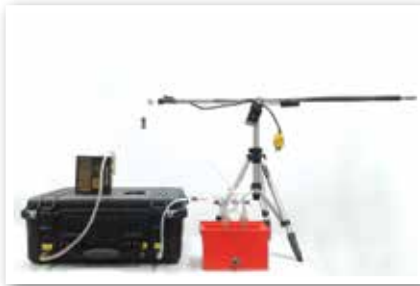
รูปที่ 3-2 อุปกรณ์ซักตัวอย่างกลิ่นจากปล่องระบายอากาศ
