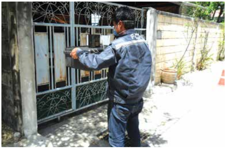
รูปที่ 3-7 แสดงการเก็บตัวอย่างกลิ่นบริเวณริมรั้วหรือขอบเขต ของแหล่งกำเนิดมลพิษ
