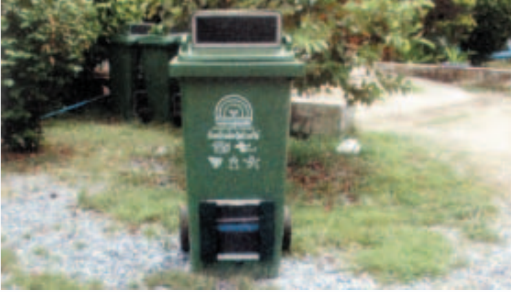
รูปที่ 5 ถังหมักขยะมูลฝอยอินทรีย์ขนาด 120 ลิตร
