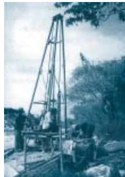
เครื่องมือเจาะทดสอบดินในสนาม
