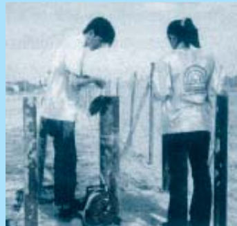
การวัดระดับน้ำนิ่งในบ่อ ก่อนเก็บตัวอย่างน้ำ
