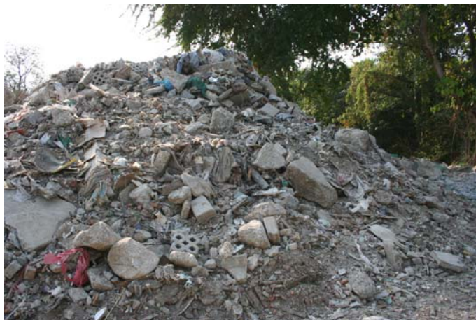
รูปที่ 2.12 ขยะและวัสดุอันตรายปนกับของเสียผสมจากการก่อสร้างและรื้อถอนจำนวนมาก (สถานที่กองเก็บที่ 4) โดยที่ ก. ขยะ กระป๋องสี ยางรถยนต์ ถุงปูน บรรจุก๊าซ กระเบื้อง พลาสติก อื่นๆ ข. บล็อกคอนกรีต แก้ว ไม้ โฟม เป็นต้น
