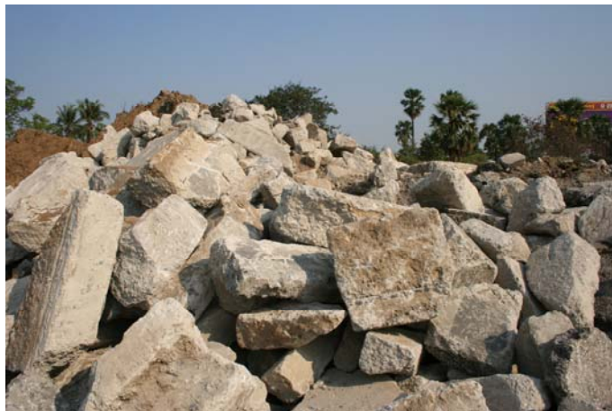
รูปที่ 2.16 กองคอนกรีตที่ผ่านการคัดแยกชนิดของเสียจากการรื้อถอนถนน (สถานที่กองเก็บที่ 5)
