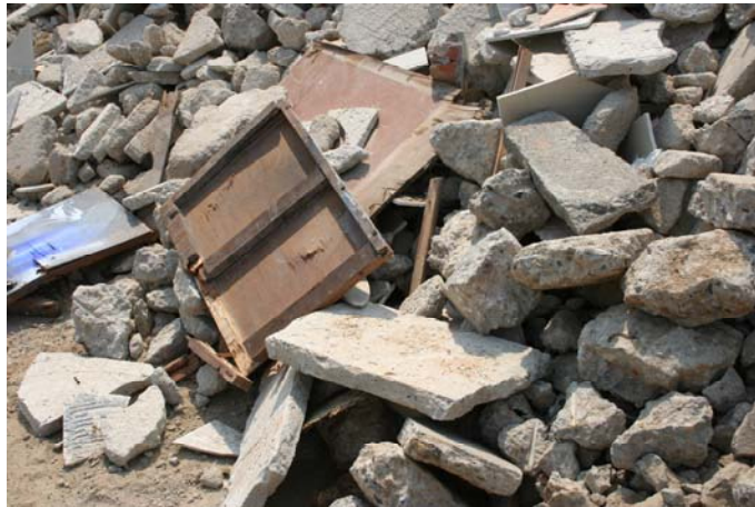
รูปที่ 2.7 โครงสร้างคอนกรีตที่ย่อยขนาดปนกับของเสียผสมจากการก่อสร้างและรื้อถอน (สถานที่กองเก็บที่ 2) โดยที่ ก. ฐานรากคอนกรีตและคอนกรีตขนาดใหญ่ ข. ผลิตภัณฑ์คอนกรีตสำเร็จรูปที่ย่อยขนาด
