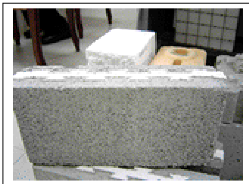
รูปที่ 4.4-1 โฟม EPS ที่ผสมคอนกรีตมีคุณสมบัติเป็นฉนวน
