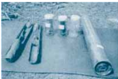
กระบอกบางและกระบอกผ่าซีก มาตรฐานใช้ในการเก็บตัวอย่างดิน
