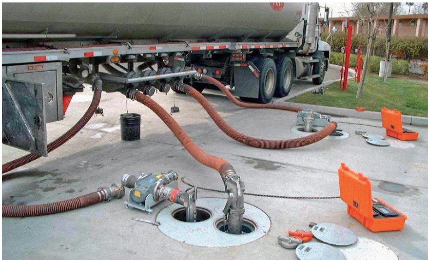
■ รูปที่ 2 วิธีขนถ่ายน้ำมันจากด้านใต้ท้องตัวถัง (Bottom Loading)
