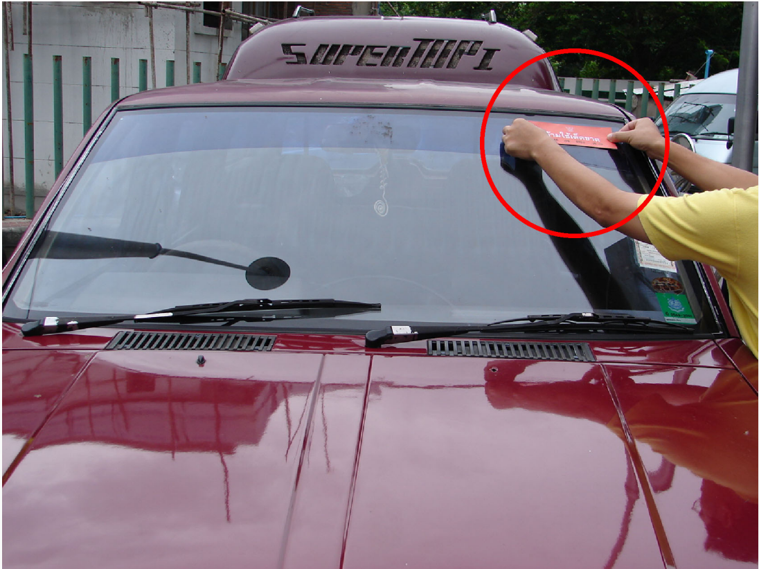
ภาพที่ 14 ตัวอย่างการติดเครื่องหมาย “ห้ามใช้เด็ดขาด” สำหรับรถยนต์ (ในวงกลม)
