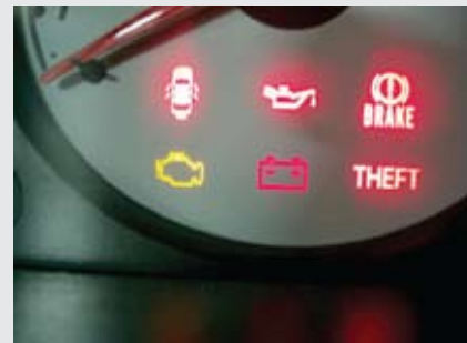
รูปที่ 1 ตัวอย่างการติดตั้งระบบ OBD ในรถยนต์ และหน้าปัดแสดงอาการผิดปกติของเครื่องยนต์ด้านหน้าของรถยนต์
