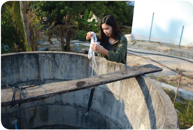
การเก็บตัวอย่างน้ำใต้ดิน ด้วยอุปกรณ์เก็บตัวอย่างน้ำใต้ดินแบบเยื่อเลือกผ่าน (PDB) จากบ่อน้ำตื้นของประชาชนบริเวณชุมชนโคตหิน ตำบลเนินพระ อำเภอเมือง จังหวัดระยอง
