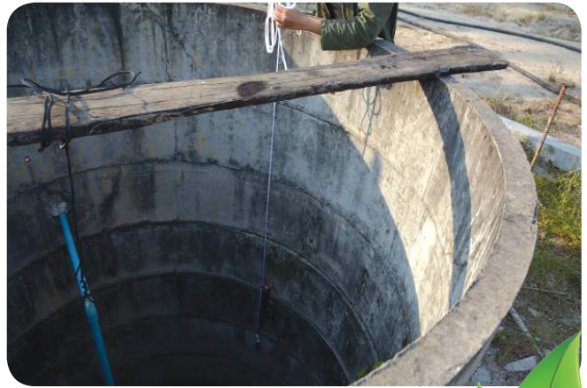
การเก็บตัวอย่างน้ำใต้ดิน ด้วยอุปกรณ์เก็บตัวอย่างน้ำใต้ดินแบบเยื่อเลือกผ่าน (PDB) จากบ่อน้ำตื้นของประชาชนบริเวณชุมชนโคตหิน ตำบลเนินพระ อำเภอเมือง จังหวัดระยอง
