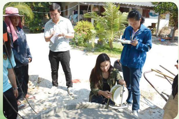
ภาพการเก็บตัวอย่างน้ำใต้ดิน ด้วยอุปกรณ์เก็บตัวอย่างน้ำใต้ดินแบบเยื่อเลือกผ่าน (PDB) จากบ่อน้ำตื้นของประชาชนบริเวณชุมชนโชดหิน ตำบลเนินพระ อำเภอเมือง จังหวัดระยอง
