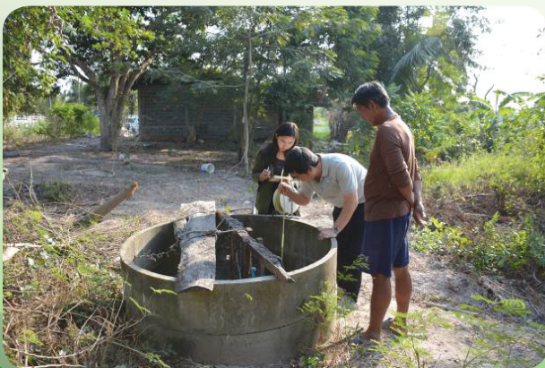
ภาพการเก็บตัวอย่างน้ำใต้ดิน ด้วยอุปกรณ์เก็บตัวอย่างน้ำใต้ดินแบบเยื่อเลือกผ่าน (PDB) จากบ่อน้ำตื้นของประชาชนบริเวณชุมชนโชดหิน ตำบลเนินพระ อำเภอเมือง จังหวัดระยอง
