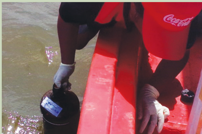
ภาพแสดงการเก็บตัวอย่างน้ำทะเล ด้วยอุปกรณ์เก็บตัวอย่างน้ำ
