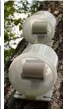
■ Passive Sampler ติดตั้งในอุปกรณ์ กันฝนและลม
