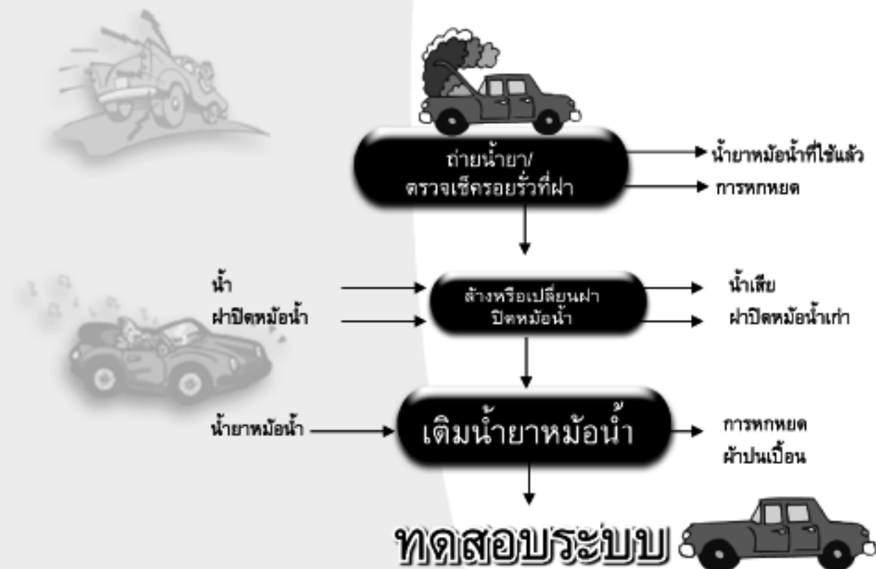
ภาพที่ 2-4: กระบวนการเปลี่ยนถ่ายน้ำมันหม้อน้ำ
