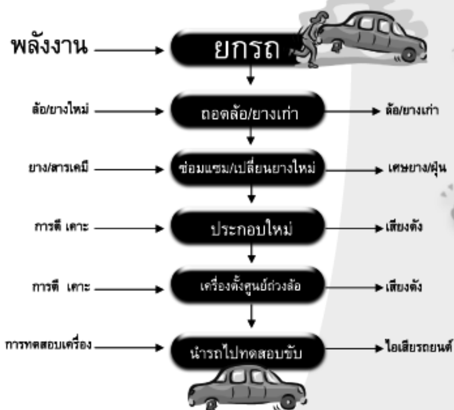
ภาพที่ 2-3: กระบวนการเปลี่ยนยางและตั้งศูนย์ล้อรถยนต์
