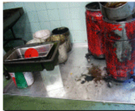
ภาพที่ 4-17: การจัดเตรียมภาชนะรองรับน้ำมันเกียร์เพื่อป้องกันการรั่วไหล
