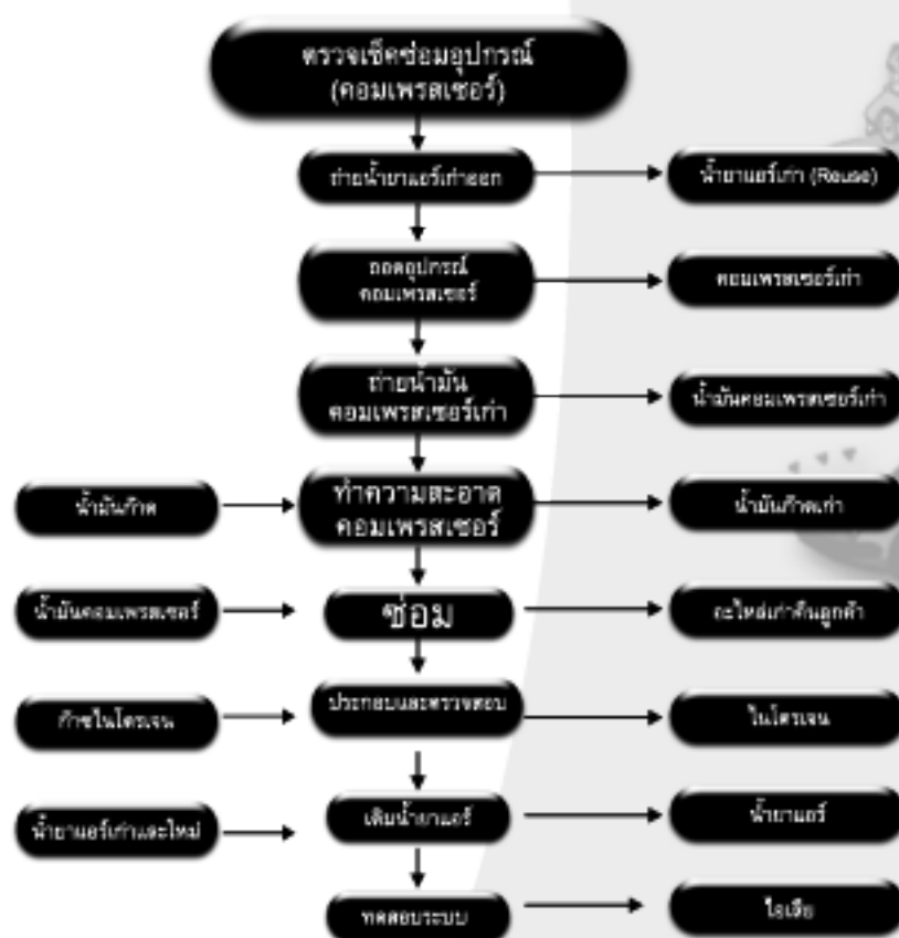
ภาพที่ 2-5: กระบวนการเปลี่ยนถ่ายน้ำยาเครื่องปรับอากาศ
