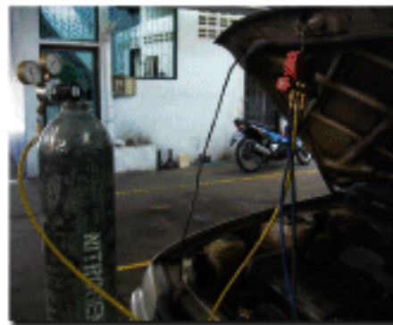
ภาพที่ 4-15: การใช้ไนโตรเจนตรวจสอบการรั่วซึมของอุปกรณ์และระบบ เครื่องปรับอากาศ
