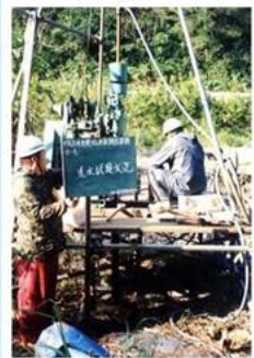
Permeability test ใช้วัดค่าการไหลของน้ำในดินเพื่อหาแนวระดับหน้าดิน โดยรวมหน้าดินด้วย
