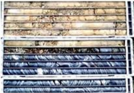
Boring core ใช้เก็บค่าดินเพื่อใช้หาแนวระดับ โดย boring machine ถ้า boring machine จะรวมเนื้อที่หน้าดินด้วย
