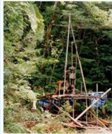
Boring machine ใช้เจาะดินเพื่อหาแนวระดับหน้าดิน
