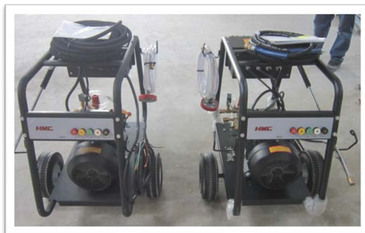
ภาพที่ 11 แสดงเครื่องฉีดน้ำแรงดันสูงเคลื่อนที่
