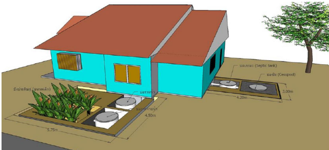
ภาพที่ ๕.๙ รูปแบบระบบสาธิตสำหรับบ้านที่มีพื้นที่นอกบ้านมาก
