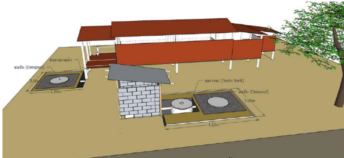
ภาพที่ ๕.๑๑ รูปแบบระบบสาธิตสำหรับบ้านที่มีพื้นที่นอกบ้านน้อย
