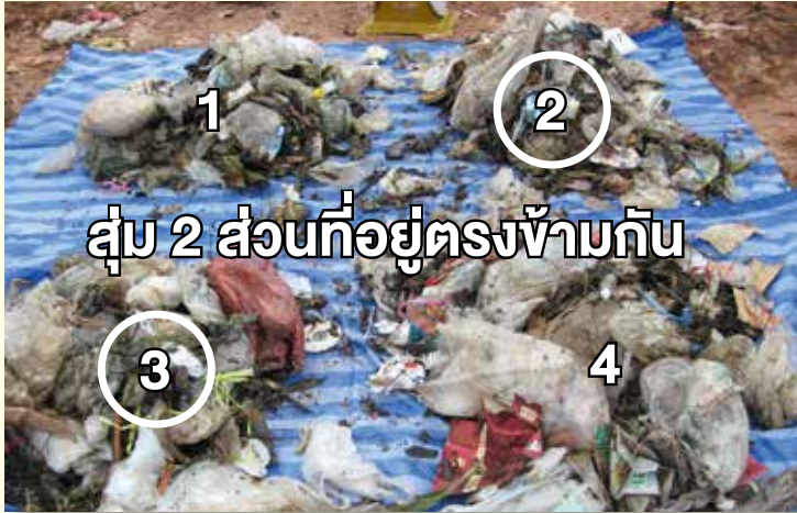
ภาพที่ ข-1 การแบ่งขยะมูลฝอยออกเป็น 4 ส่วน (Quartering) และเลือกสุ่มเอามา 2 ส่วน ที่อยู่ตรงข้ามกัน
