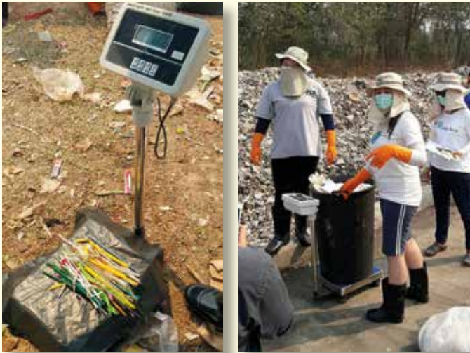
ภาพที่ ข-2 การหาความหนาแน่น (Bulk Density) ของตัวอย่างขยะมูลฝอย
