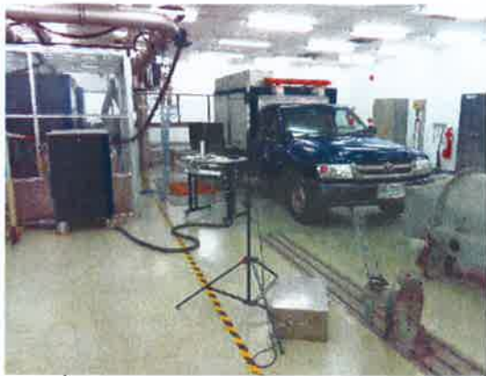
รูปที่ 3 ภาพการตรวจวัดระดับเสียงขณะทำงาน ภายในห้องทดสอบมลพิษจากรถยนต์เบนซิน
