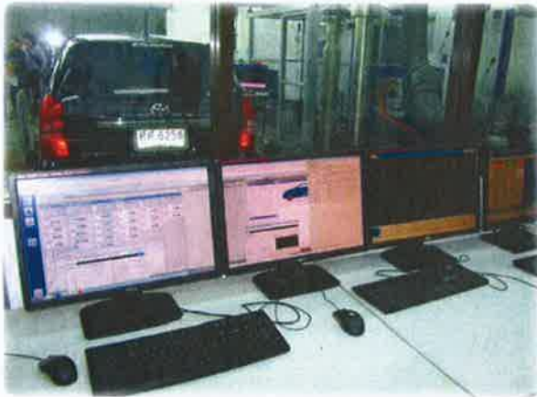
รูปที่ 1 ภาพห้องควบคุมการทดสอบรถยนต์ตัวอย่าง (Control Room)
