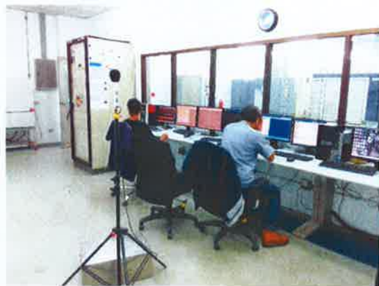
รูปที่ 4 ภาพการตรวจวัดระดับเสียงขณะทำงาน ภายในห้องควบคุมระบบทดสอบมลพิษจากรถยนต์เบนซิน
