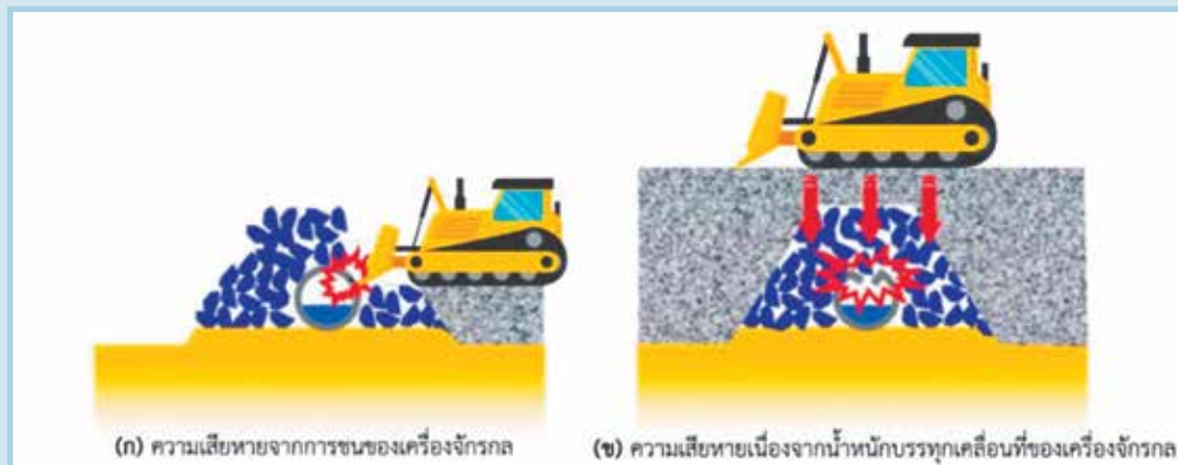
รูปที่ 63 ลักษณะความเสียหายกับท่อรวบรวมน้ำชะขยะในบริเวณการฝังกลบขยะในชั้นแรก
