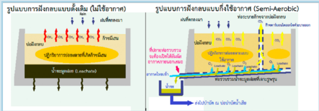
รูปที่ ก. การเปรียบเทียบปฏิกิริยาชีวเคมีระหว่างบ่อฝังกลบขยะแบบดั้งเดิมและแบบกึ่งใช้อากาศ (ที่มา Fukuoka City Environment Bureau, 1999 อ้างใน A Practical Guide to Landfill Management in Pacific Island Countries and Territories, SPREP and JICA, March 2010)
