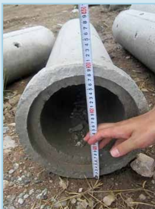
รูปที่ 32 การวัดความยาวและเส้นผ่าศูนย์กลางของท่อ
