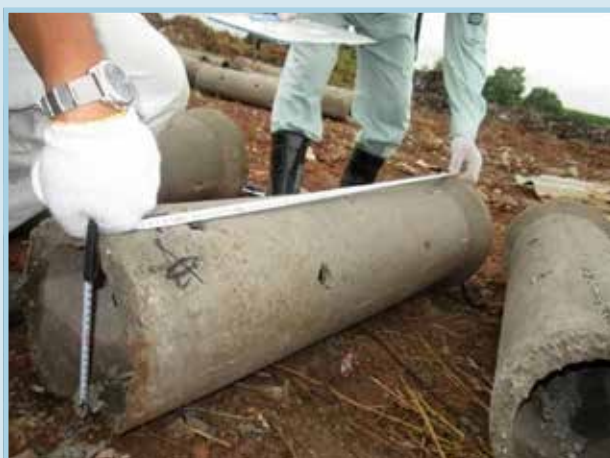
รูปที่ 32 การวัดความยาวและเส้นผ่าศูนย์กลางของท่อ
