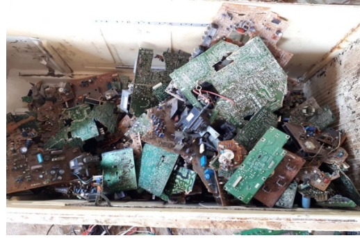
รูปที่ ๒-๑๐ การคัดแยกและรวบรวมแผ่นวงจรอุปกรณ์อิเล็กทรอนิกส์
