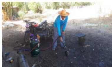
รูปที่ ๒-๙ การผ่าคอมเพรสเซอร์เครื่องปรับอากาศและตู้เย็น
