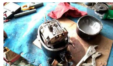
รูปที่ ๒-๙ การผ่าคอมเพรสเซอร์เครื่องปรับอากาศและตู้เย็น
