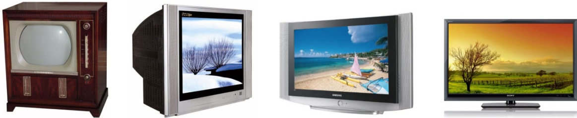
รูปที่ ๕-๑ โทรทัศน์แบบต่างๆ เริ่มจากโทรทัศน์ขาวดำ โทรทัศน์สีที่ใช้หลอดภาพรังสีคาโทด จอภาพพลาสมา และจอภาพแบบแอลซีดี (จากซ้ายไปขวา)
