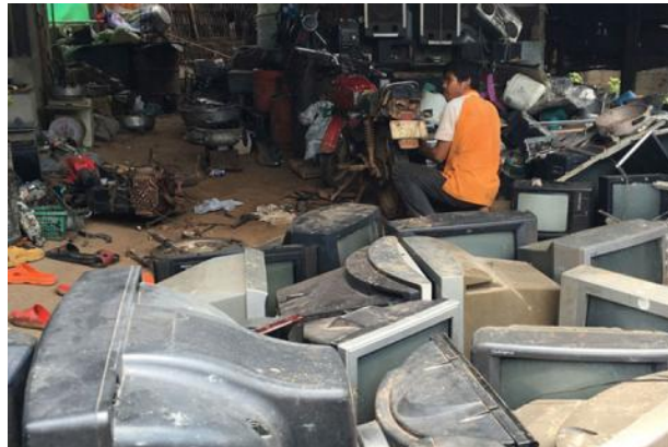
รูปที่ ๓-๑ สภาพการถอดแยกซากเครื่องใช้ไฟฟ้าฯ บนพื้นดินภายในบริเวณบ้านที่มีความเสี่ยงของการปนเปื้อนโลหะหนักในดิน
