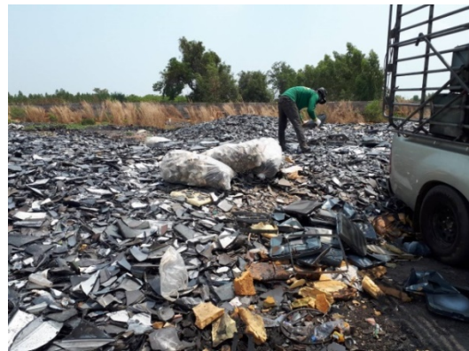
รูปที่ ๒-๘ ตัวอย่างการถอดแยกจอโทรทัศน์รุ่นเก่าและการทุบจอเพื่อแยกโครโมโลหะไปขาย
