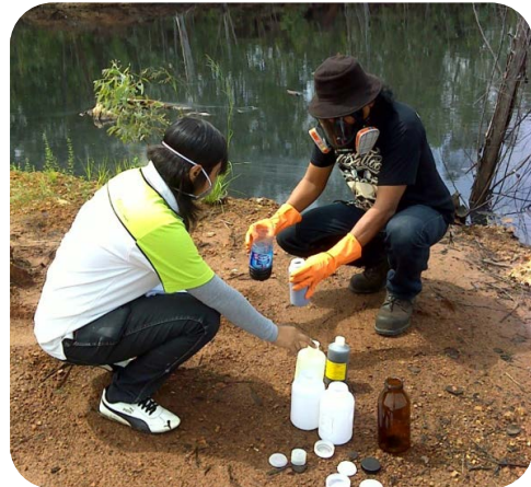
รูปที่ ๒-๒ การตรวจวัดไอระเหยสารเคมีจากกากของเสีย
