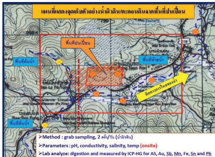
รูปที่ 4-3 แผนที่แสดงการกำหนดจุดเก็บตัวอย่างน้ำผิวดินและตะกอนดินเพื่อตรวจสอบการปนเปื้อน
