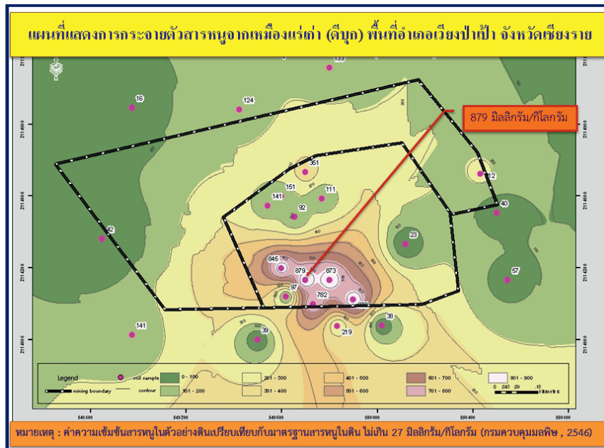
รูปที่ 4-5 ตัวอย่างแผนที่แสดงการกระจายตัวการปนเปื้อนสารหนู (Arsenic)
