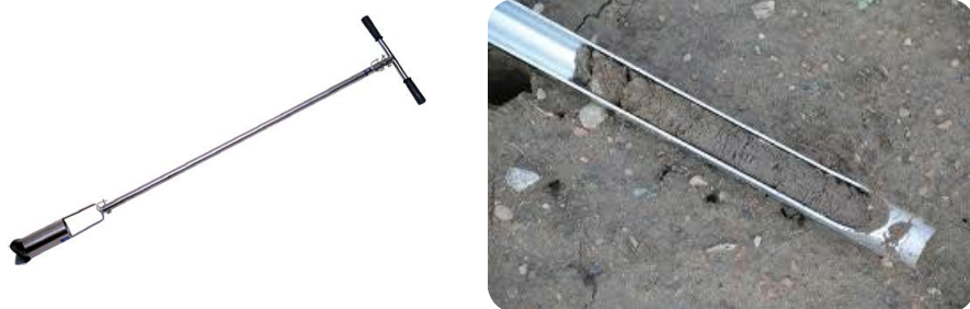
รูปที่ ข-4 หัวเจาะดิน (Hand Auger) และ Thin-wall Tube Sampler
