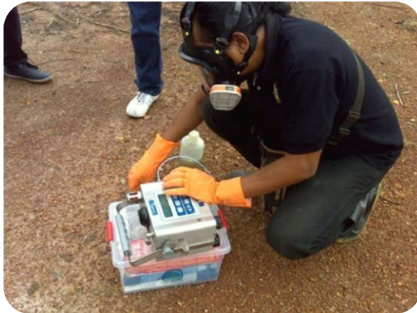
รูปที่ ๒-๒ การตรวจวัดไอระเหยสารเคมีจากกากของเสีย
