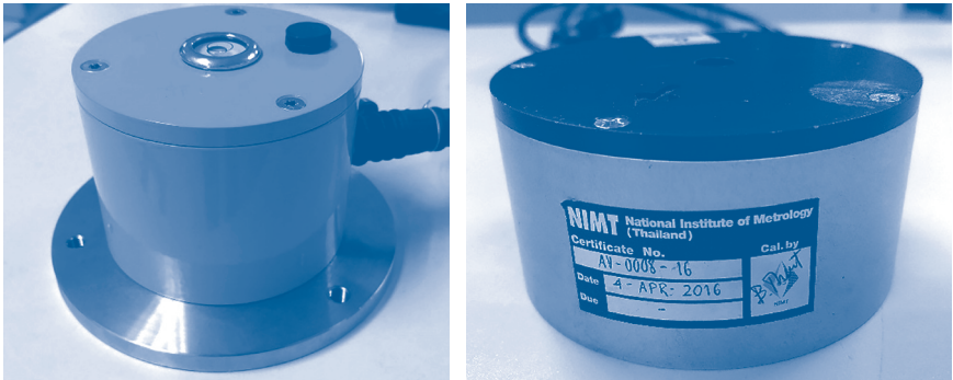
รูปที่ 5 ตัวอย่างหัววัดความสั่นสะเทือน
