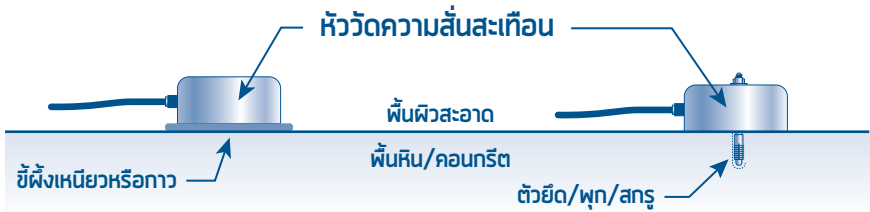
รูปที่ 13 การติดตั้งหัววัดความชื้นสัมเทือนที่พื้นอาคาร
