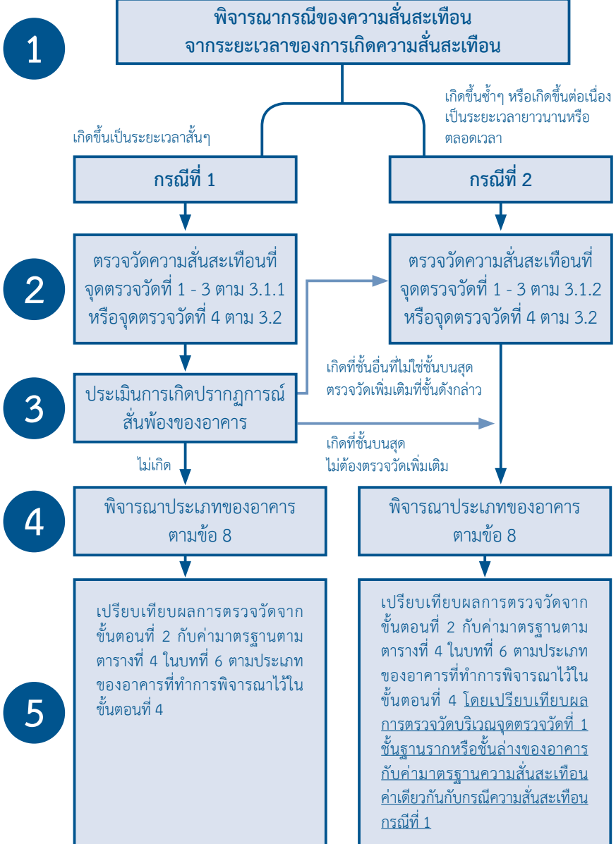
รูปที่ 16 แผนผังขั้นตอนการตรวจวัดความสั่นสะเทือนเพื่อป้องกันผลกระทบต่ออาคาร
