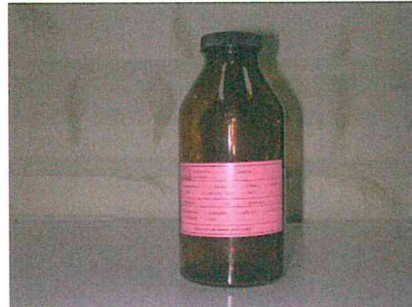
ขวดเก็บตัวอย่างน้ำเพื่อวิเคราะห์ Oil&Grease
