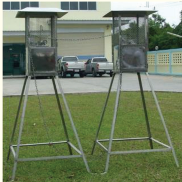
รูปที่ ๕-๔ การเก็บตัวอย่างอากาศเข้าสู่ถังเก็บตัวอย่างอากาศ (Canister)
