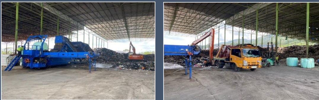
การอัดและห่อมัดก้อนขยะด้วยแผ่นพลาสติก HDPE ของเทศบาลนครเกาะสมุย เพื่อไปกำจัดบนฝั่ง
