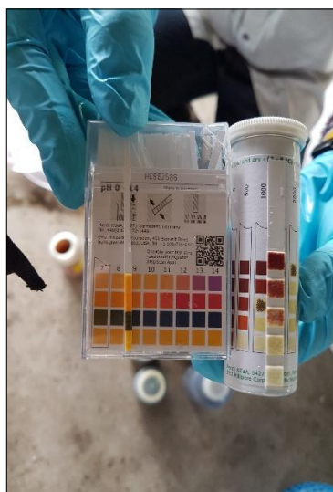
รูปที่ ๘ การเทียบค่าความเป็นกรดและด่างกับกระดาษลิตมัส
