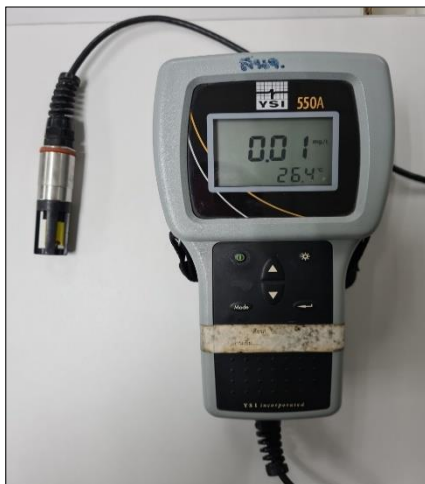
รูปที่ ๑๐ เครื่องวัดออกซิเจนละลายน้ำ (DO Meter)
