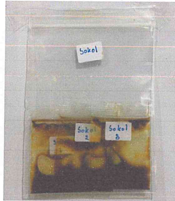
รูปที่ ๑ การบรรจุตัวอย่างน้ำมันดิบที่ทำการสุ่มเพื่อวัดด้วยเทคนิคการเรืองรังสีเอกซ์ โดยการบรรจุในถุงพลาสติก Polyethylene zipper bag
